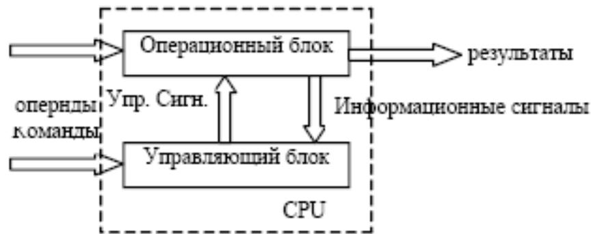
Управляющий блок выдает последовательность сигналов, которые обеспечивают выполнение данной команды. Информационные сигналы зависят не только от исходных значений, обрабатываемых данных, но и от результатов, получаемых в процессе обработки.
